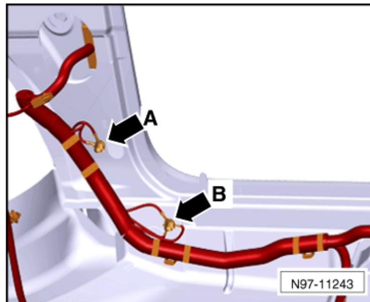
47 Point de masse, au plancher avant droit -flèche B-
