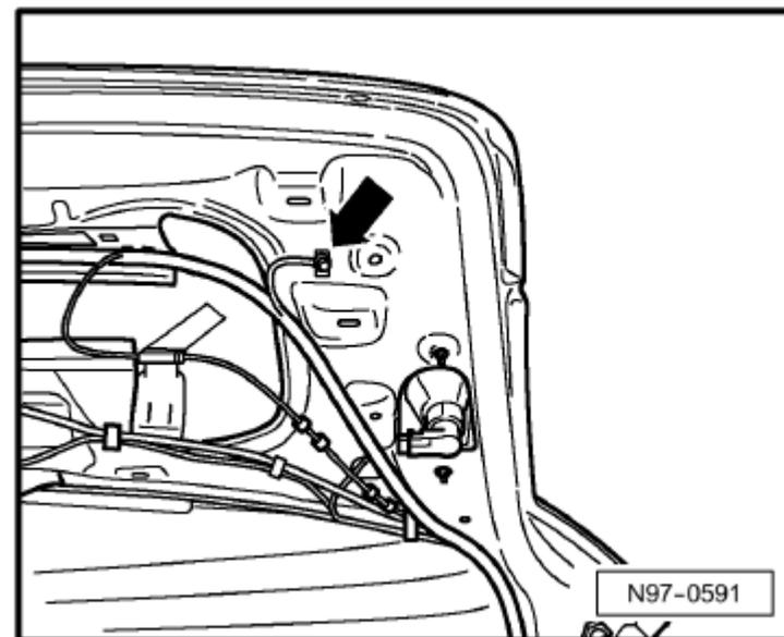
50 Point de masse, à gauche dans le coffre à bagages-flèche B-
