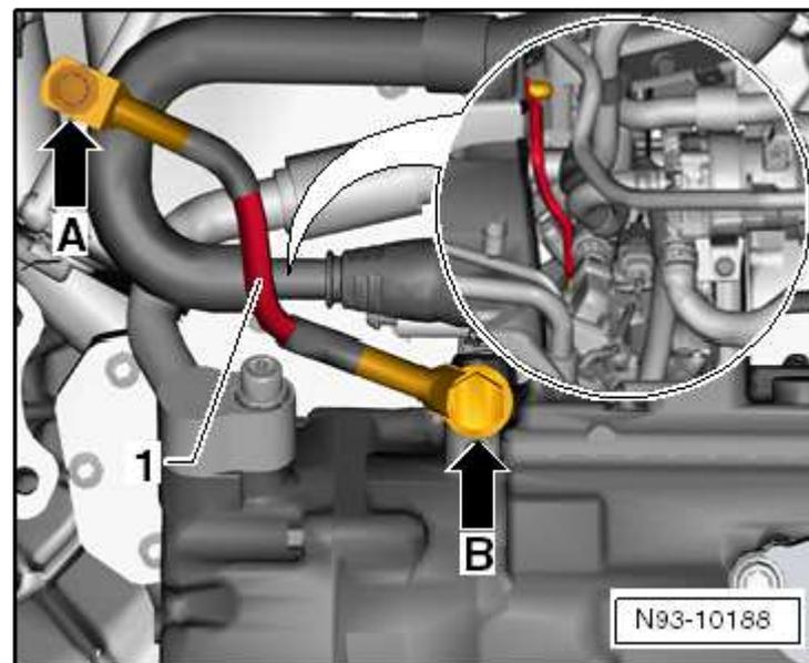
609 Point de masse, à droite dans le caisson d'eau -flèche-
