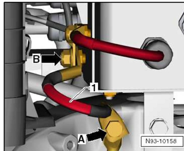
607 Point de masse, à gauche dans le caisson d'eau -flèche-
