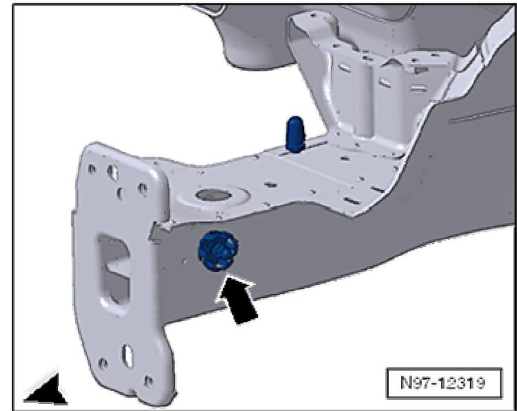
652 Point de masse pour masse de boîte de vitesses et de moteur -flèche D-
